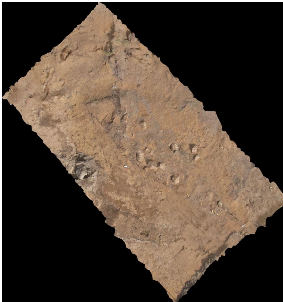
Figur 6.3: Exempel på georefererad fotogrammetri-illustration gjord i Agisoft Photoscan. I detta fall båtgrav A2713. Illustration Christian Roll Valen
